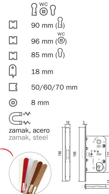
Pestillo magnético: de diseño y silencioso. El frontal se coloca con una leve presión. Es posible la personalización de la cerradura al gusto y estilo propio.
